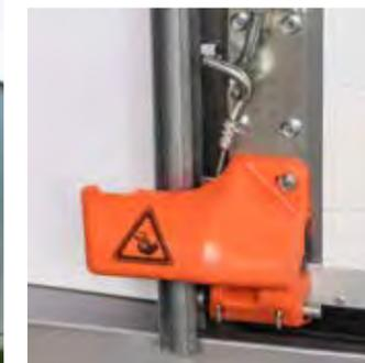
⊕ Для максимальной безопасности промышленные ворота оснащены устройством безопасности (тормоза-улавливатели) против падения ворот, которые автоматически активизируются в случае разрыва троса. Новые тормоза-улавливатели оснащены специальной защитой от взлома.
